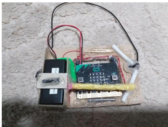
СЛИКА 8. Primer primene mikro bita-toplomer FIGURE 8. Example of application of Microbit.- measure of temperature
