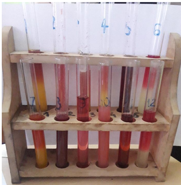
СЛ. 9. Епрувете након додавања сока од црвеног купуса FIG. 9. Tubes after adding red cabbage juice
