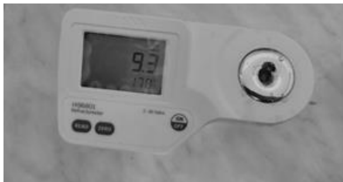
СЛИКА 6: Очитана вредност садржаја шећера у Benni црвени клакеру FIGURE 6: Read value of sugar content in Benni red clacker
