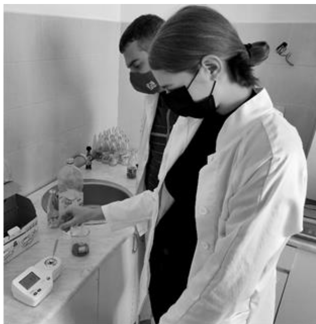
СЛИКА 3. Додавање узорка у HANNA рефрактометар FIGURE 3. Putting the sample in HANNA refractometer
