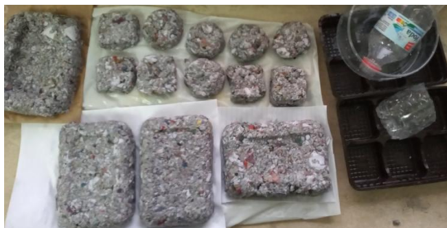
СЛИКА 6. Поставити пелет на суво место; Нека се суше три до седам дана FIGURE 6. Place the pellets in a dry place; Let dry for three to seven days.
