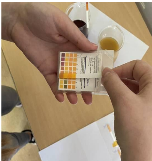
Сл.4Одређивање рН вредности према табели универзалног индикатора Merck Fig.4Specify an pH value according to the Merck Universal Indicator table
