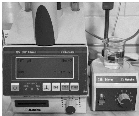
СЛИКА 8: Очитана вредност искоришћене запремине NaOH FIGURE 8: Read value of NaOH volume used
