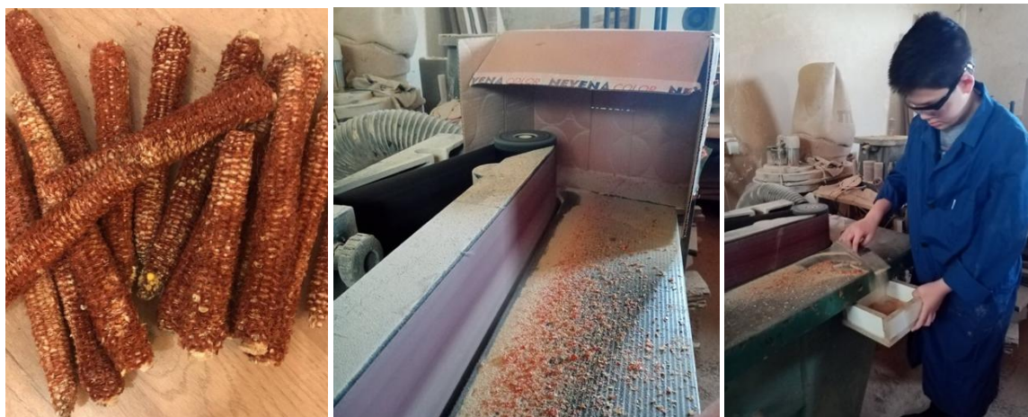
СЛИКА 4.Окласак ; Окласак у праху; Сакупљање самлевене трине од окласака FIGURE 4.Maize Cob; Maize Cob powder; Collecting ground trina from corn cobs
