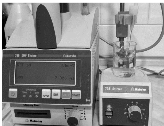
СЛИКА 6: Очитана вредност искоришћене запремине NaOH FIGURE 6: Read value of NaOH volume used
