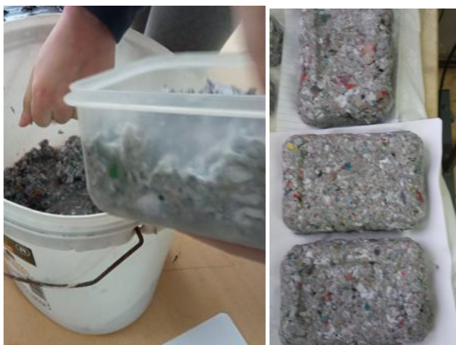
СЛИКА 5. Исцедити вишак воде ; Извадити из калупа FIGURE 5. Drain excess water; Remove from the mold
