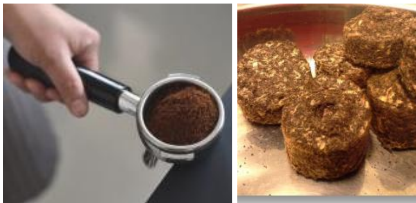
СЛИКА 1. Брикет од отпада од кафе(талога) и отпадног папира у масеним односима 80:20 FIGURE 1. Briquette of coffee waste (sludge) and waste paper in mass ratios of 80:20
