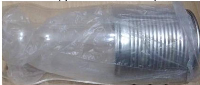
СЛИКА 4. Пробушити пластичну кесу да се направи облога; Додати пелет у калуп FIGURE 4. Pierce the plastic bag to make a coating; Add the pellets to the mold.
