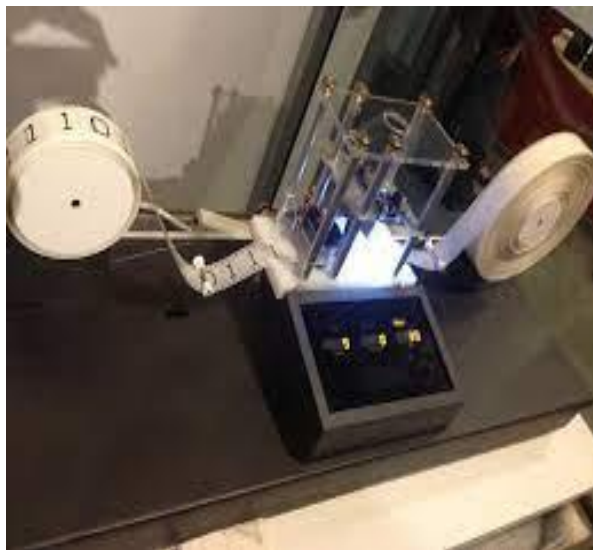
Слика 1-Прототип Тјурингове машине
