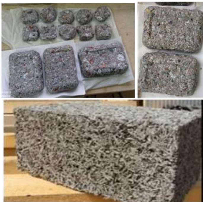
СЛИКА 6. Сушење блока три до седам дана FIGURE 6. Drying block for three to seven days
