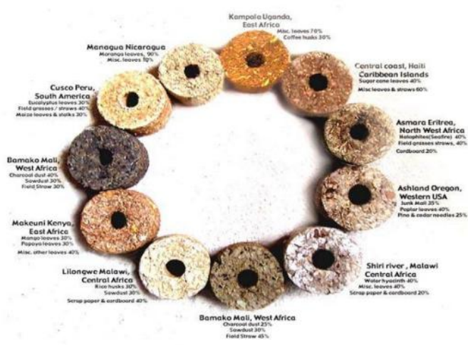
СЛИКА 8. Узорци пелета из целог света FIGURE 8. Samples of briquettes from around the world
