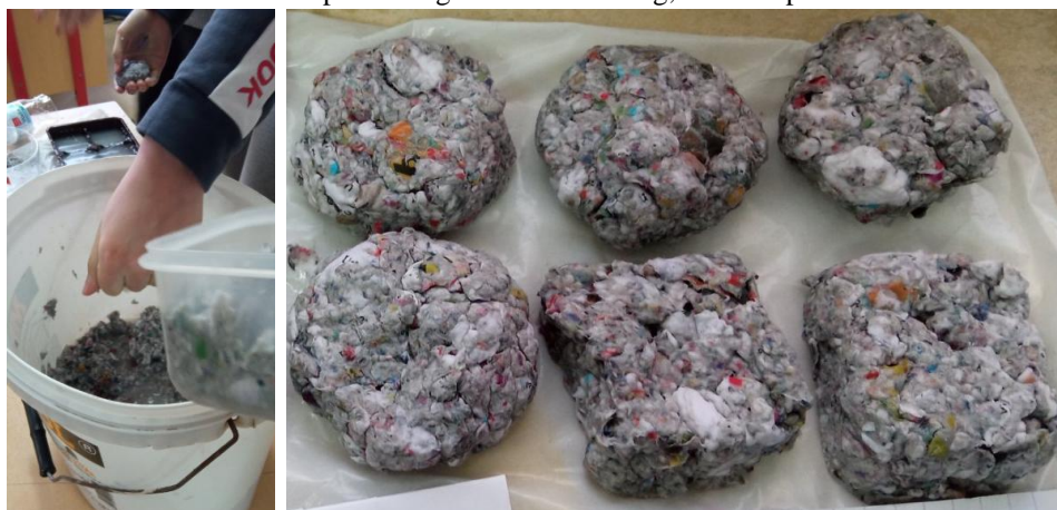
СЛИКА 5 Исцедити вишак воде конзервом; Извадити пелет из калупа FIGURE 5. Drain excess water with a can; Remove the pellets from the mold
