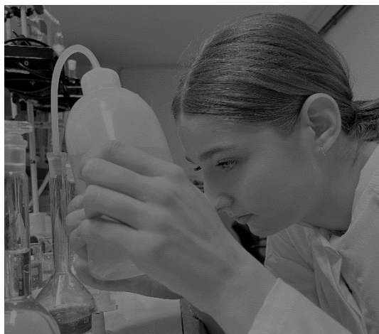
СЛИКА 5: Пуњење нормалног суда демиводом FIGURE 5: Filling of volumetric flask with demiwater
