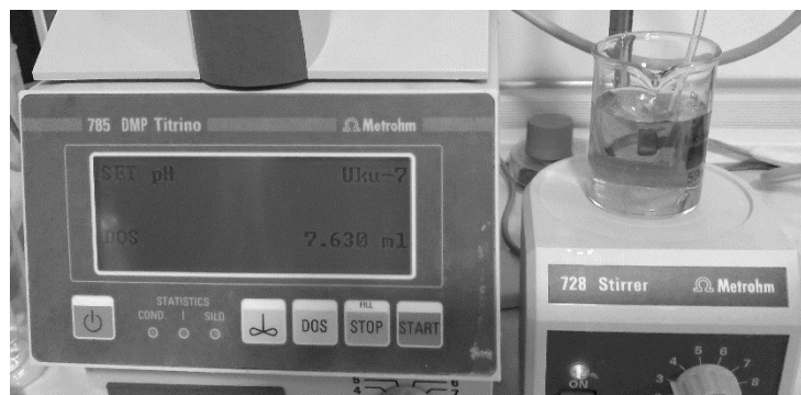
СЛИКА 14: Очитана вредност искоришћене запремине NaOH FIGURE 14: Read value of NaOH volume used
