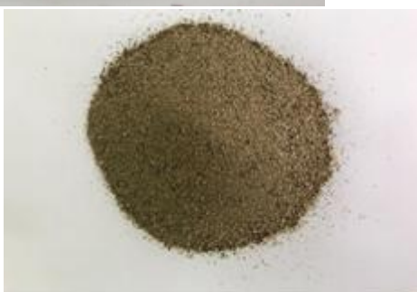
СЛИКА 4. Цемент и песак додат пулпи од папира; смеша додата у правоугаони или округли калуп FIGURE 4. Add cement and sand; mixture added to a rectangular or round mold
