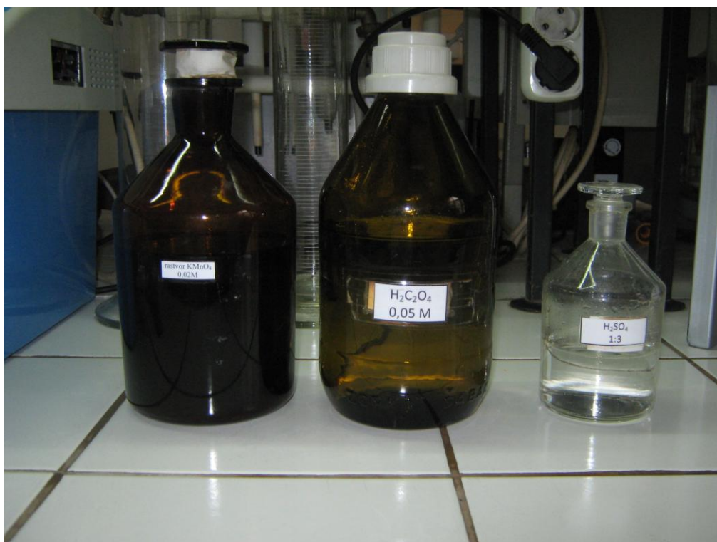
Slika 2 – Rasvori korišćeni prilikom određivanja potrošnje \text{KMnO}_4 ( \text{KMnO}_4 , \text{H}_2\text{C}_2\text{O}_4 i \text{H}_2\text{SO}_4 )
