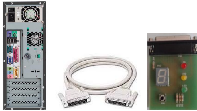
Сл.1. РСрачунарсাপаралелнимпортом, каблзавезу, модул
