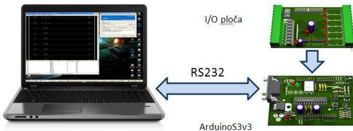
Sl.5.10 – Principijelni prikaz veze PC-ArduinoS3v3-I/O ploče
