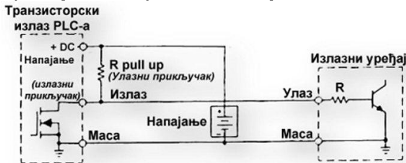
Sl.2.5 - Sprega tranzistorskog izlaza PLC-a i izlaznog uređaja NPN tipa.
